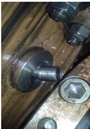
Zdjęcie nr 5. Uszkodzony sworzeń koła zębatego pośredniego napędu rozrządu.
