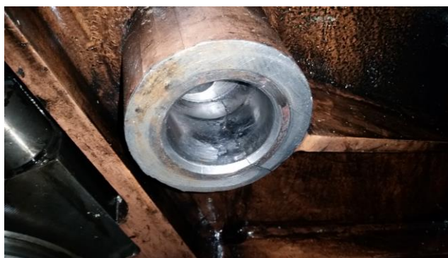
Zdjęcie nr 4. Pęknięty blok silnika w miejscu posadowienia sworznia koła zębatego pośredniego napędu wału rozrządu PB
