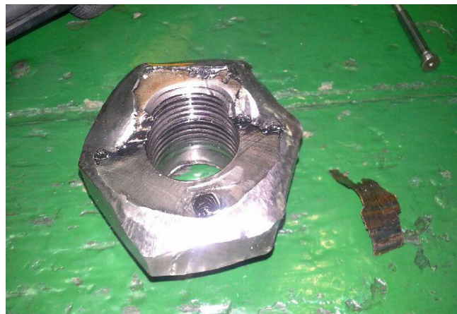
Zdjęcie nr 6. Uszkodzona nakrętka mocująca sworzeń koła zębatego pośredniego.
