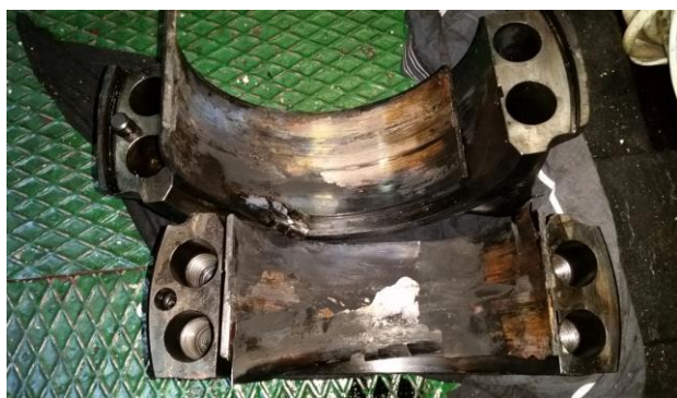
Zdjęcie nr 3. Uszkodzone panewki wału korbowego czopów głównych
