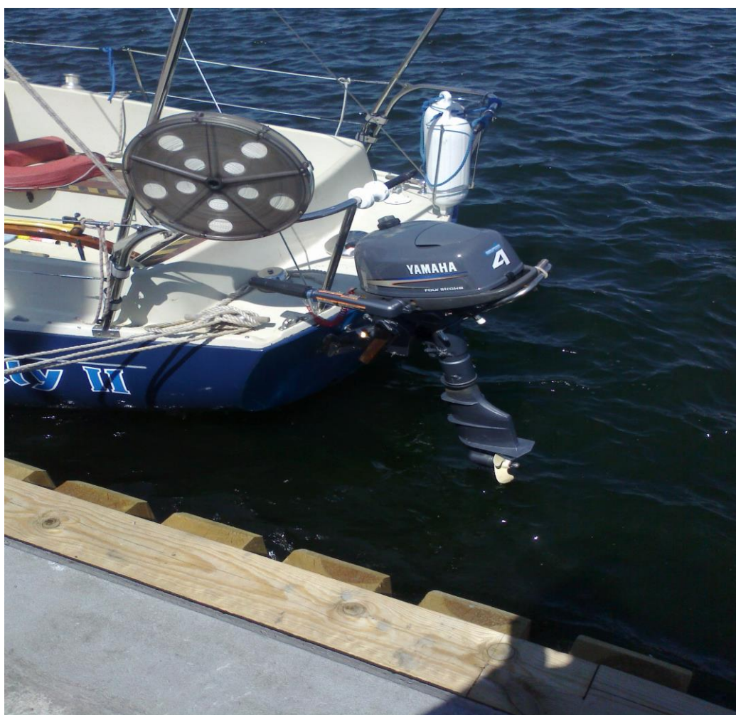
Zdjęcie nr 2. Widok na zamocowany na rufie jachtu silnik zaburtowy
