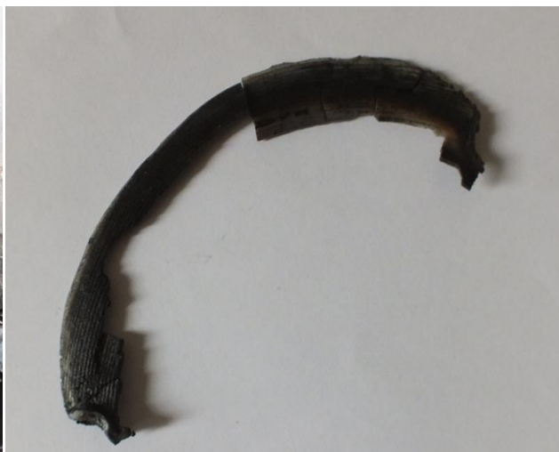
Zdjęcie nr 6. Fragmenty uszkodzonej uszczelki z połączenia kołnierzowego na łączniku pompy
