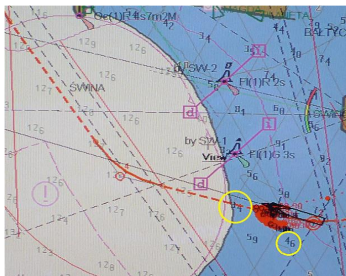
Rysunek 2 Zrzut ekranu systemu ECDIS na statku Peak Bergen z planowaną trasą podróży ze wskazaniem aktualnych głębokości akwenu.
