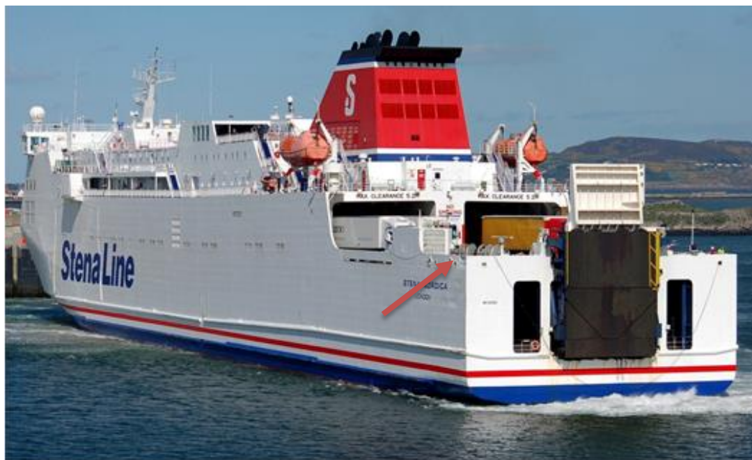
Zdjęcie 5 - Układ kluz i rampa rufowa na lewej rufie „Stena Nordica” ( www.shipspotting.com , autor: Willie Ryan) – przed przebudową tj. bez tzw. Duck Taila na rufie.
