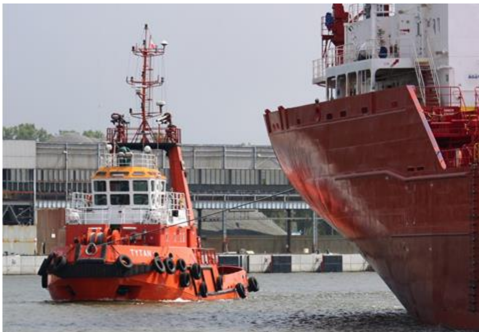
Zdjęcie 7 – „Tytan” pracujący jako holownik asystujący na rufie w trybie „in-direct” i jego urządzenia holownicze w postaci przewłoki holowniczej dziobowej (www.wobiektywieshipspottera.blogspot.com, autor: W. Danielewicz)
