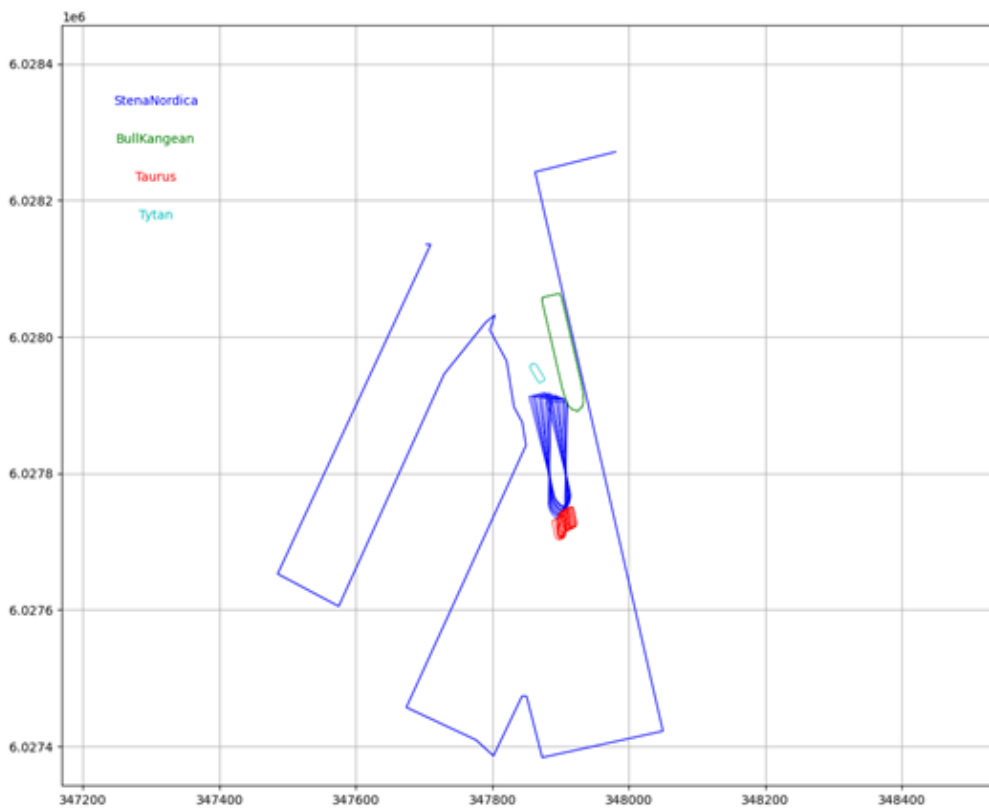
Rys. 5 - Odtworzenie przejścia zestawu holującego statek SN za pomocą połączonych informacji AIS i VDR statku SN dla Etapu 3 (układ UTM, siatka co 200m)
