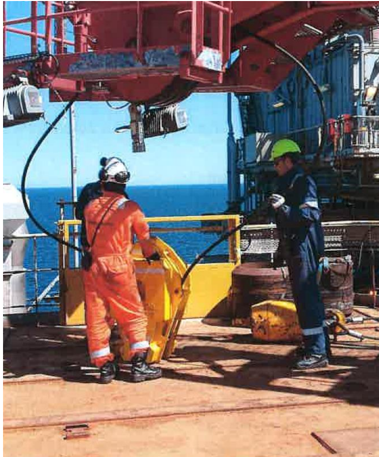
Zdjęcie nr 3. Zblocze hakowe ustawione na pokładzie geofizycznym platformy
