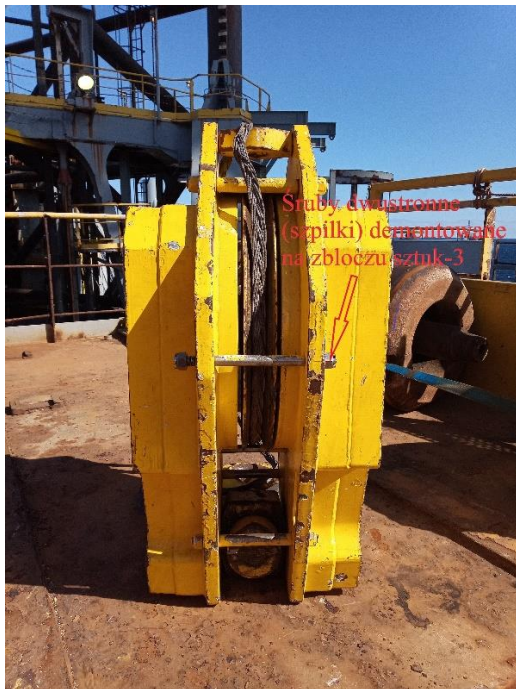
Rysunek 2. Demontowane śruby dwustronne (szpilki) na zbloczu hakowym przez starszego marynarza
