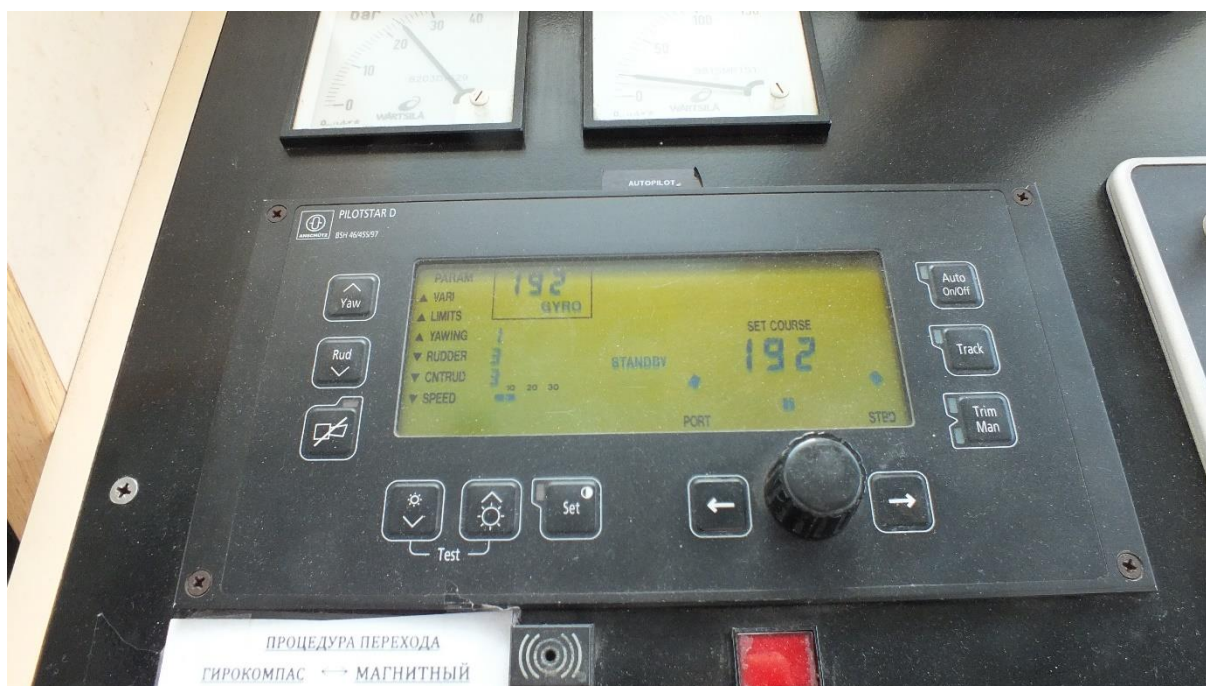
Zdjęcie nr 6. Panel autopilota z widoczną poniżej instrukcją wyboru sygnału z żyrokompasu lub z kompasu magnetycznego
