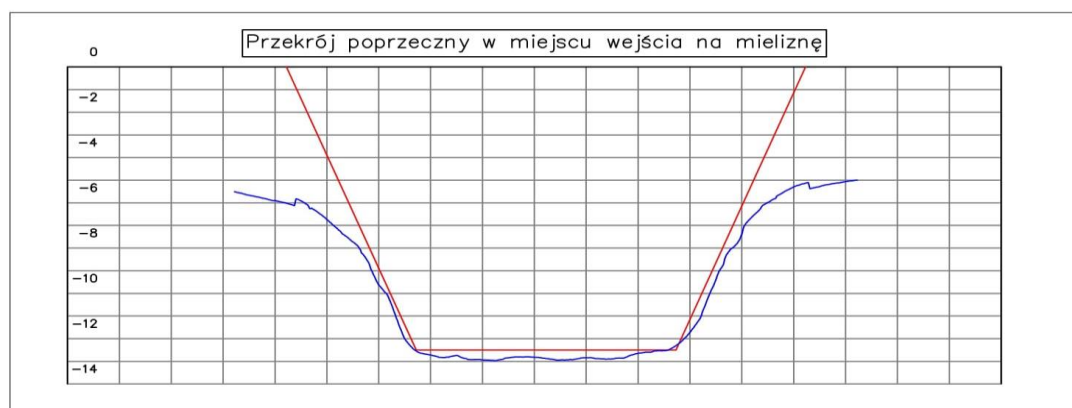
Rysunek 8. Parametry toru wodnego w miejscu wejścia statku na mieliznę
