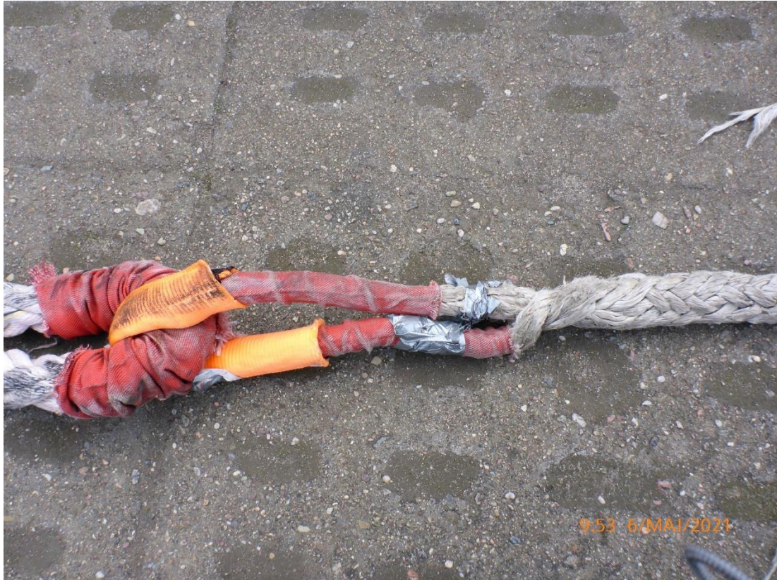
Zdjęcie 3 – Sposób połączenia odcinków liny holowniczej.
