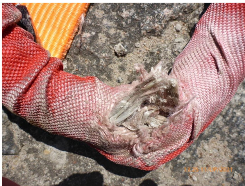
Zdjęcie 9 – uszkodzenia widoczne po zdjęciu osłony z oka liny.
