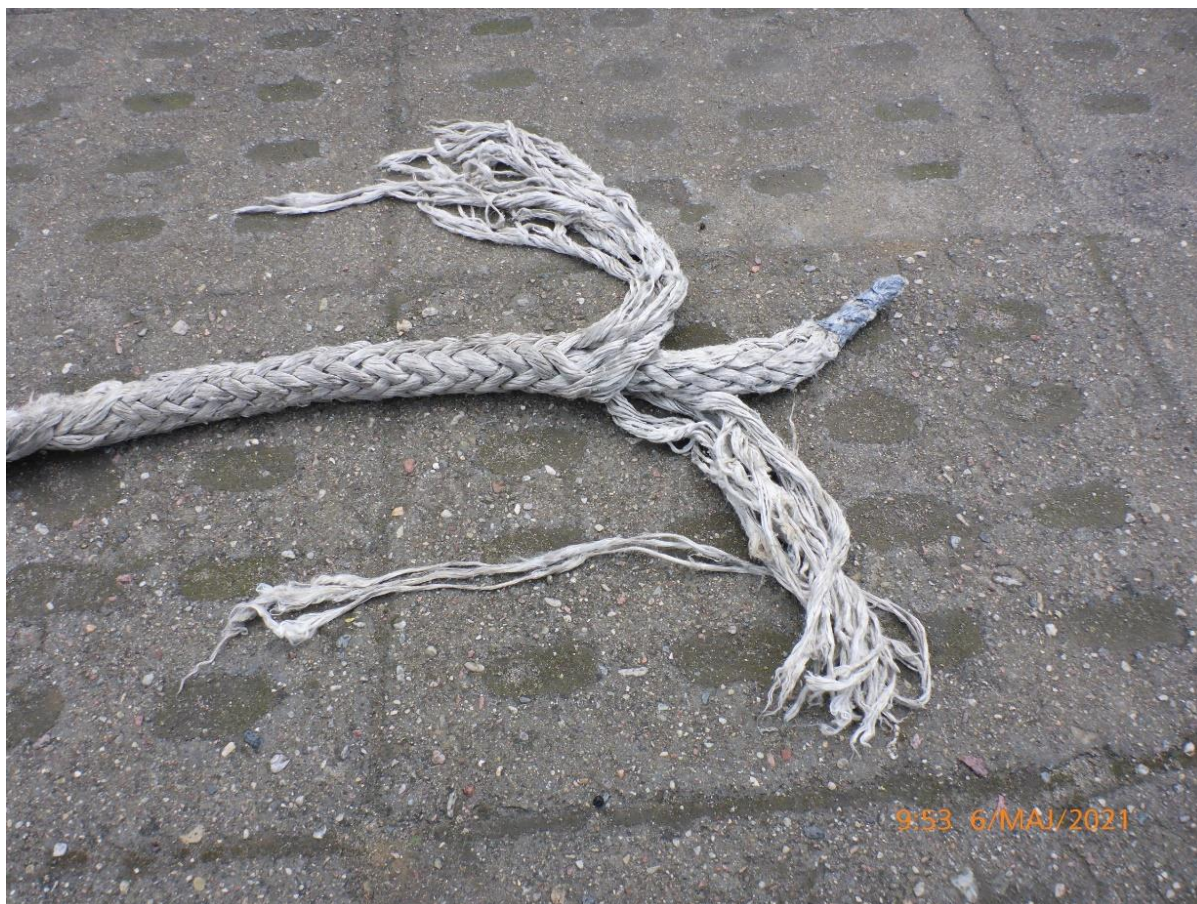
Zdjęcie 6 – końcówka uszkodzonej liny HMPE
