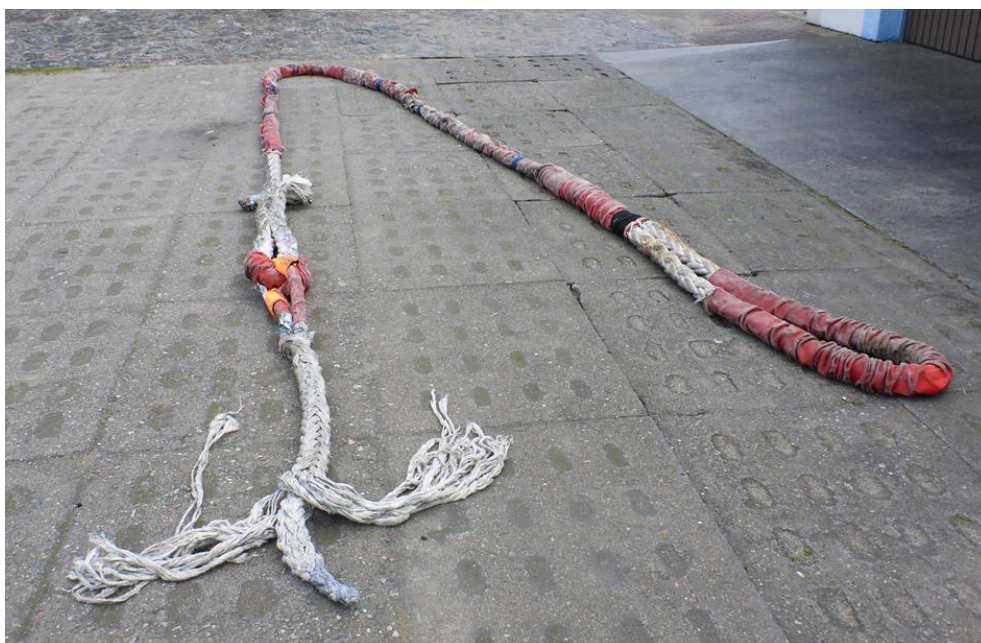
Zdjęcie 4 – Odcinek liny traktowanej jako „sprężyna” oraz końcówka urwanego holu.
