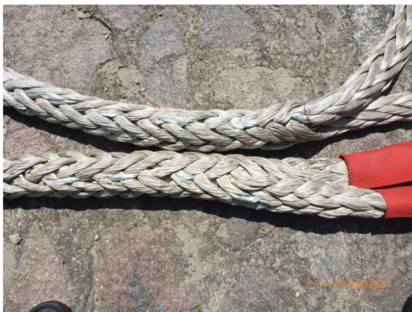
Zdjęcie 8 - Prawidłowo zaplecione oko liny HMPE z widocznymi przeszyciami ograniczającymi przesuwanie się końcówek zaplecionych pokrętek.
