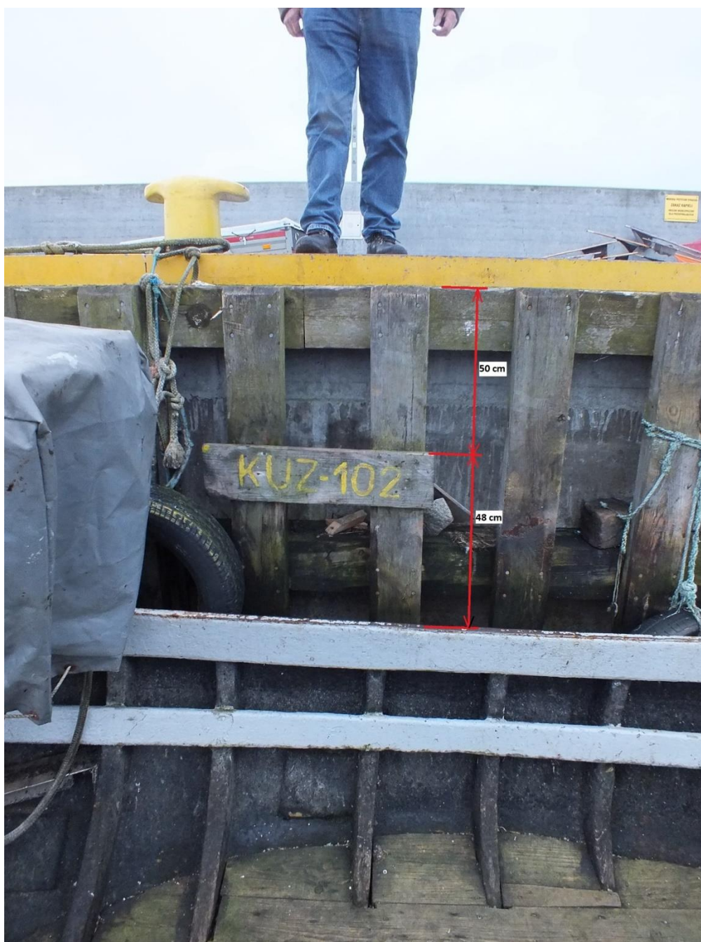
Zdjęcie 3 - Burta łodzi KUŻ-102 i deska po której chciał wyjść załogant. Zaznaczone odstępki: burta-stopień i stopień-nabrzeże)
