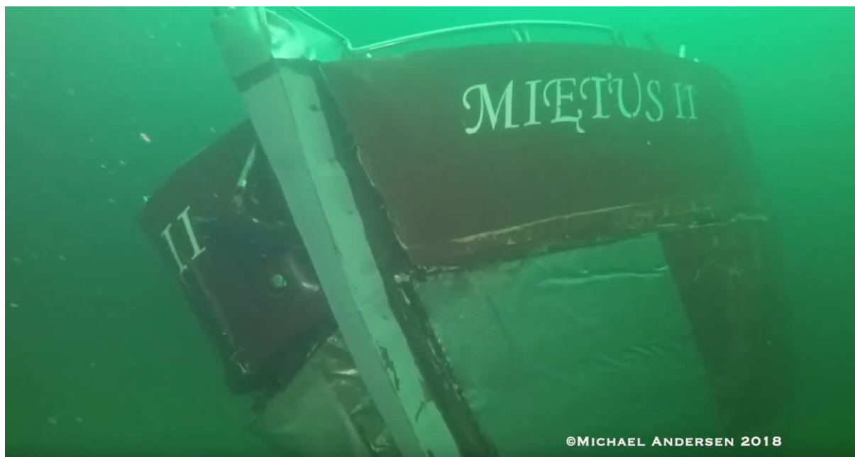
Zdjęcie nr 9 Uszkodzenie części dziobowej jachtu Miętuś II
