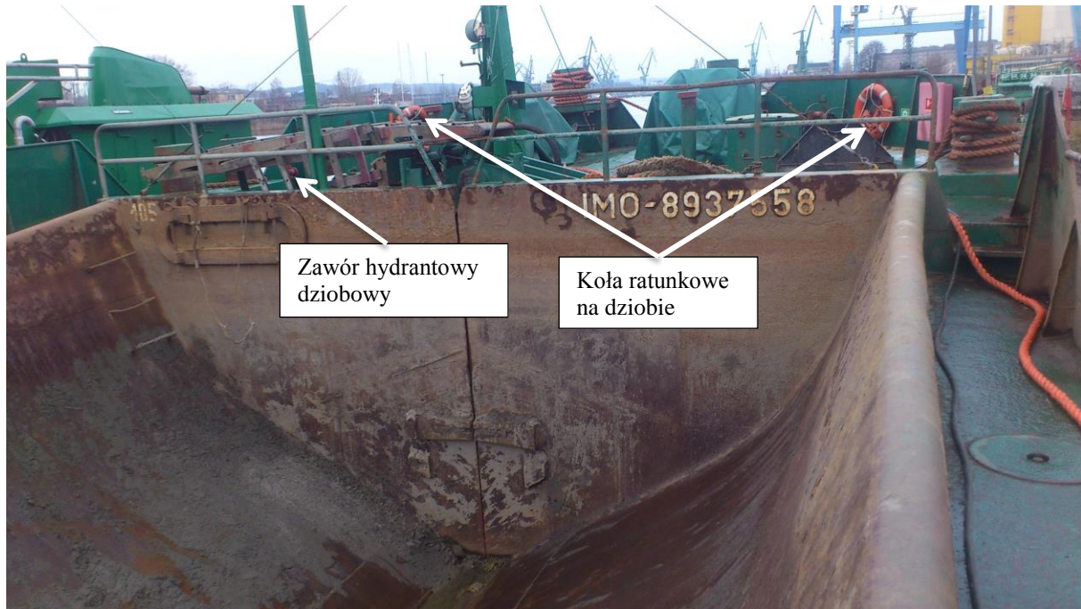
Zdjęcie nr 2. Rozmieszczenie hydrantu i kół ratunkowych na szalandzie PRC 105
