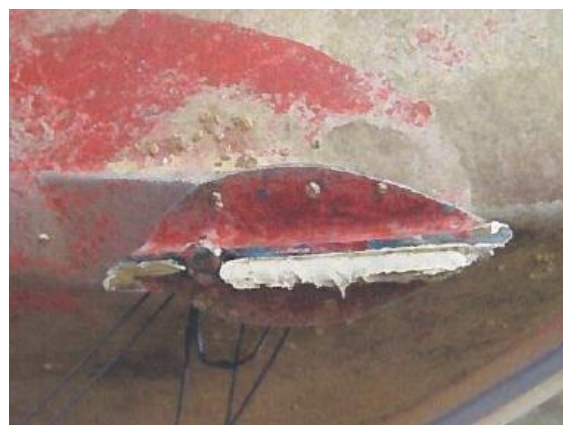
Zdjęcie nr 6. Widoczny ślad po odłamanej płetwie sterowej
