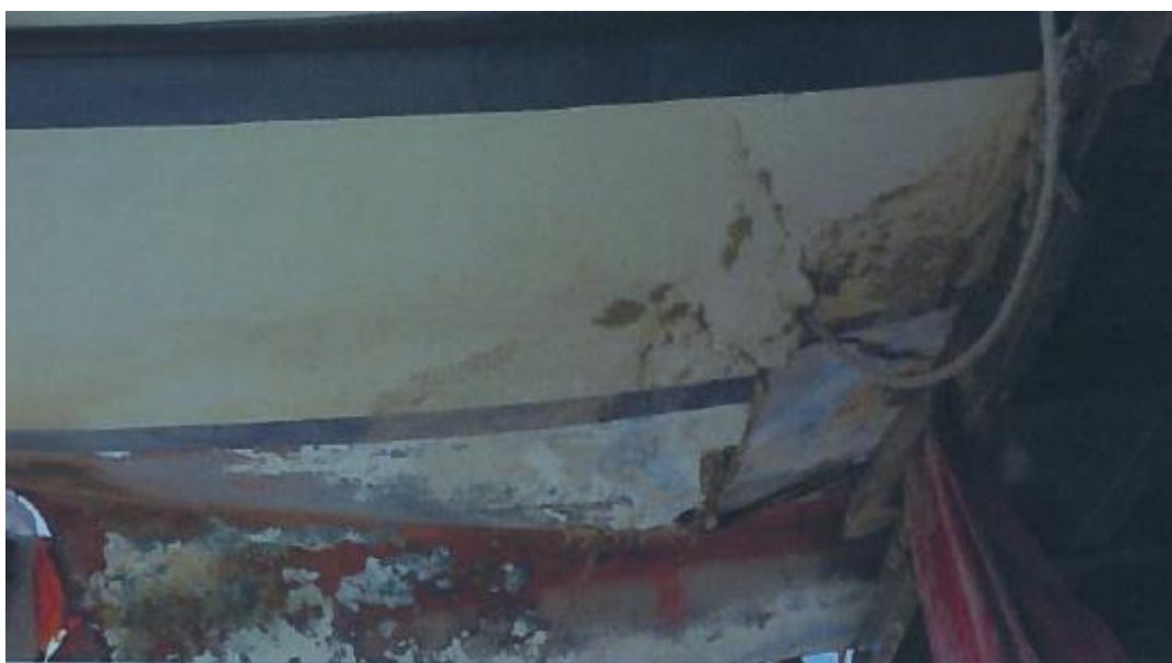
Zdjęcie nr 3. Widoczna delaminacja na kadłubie
