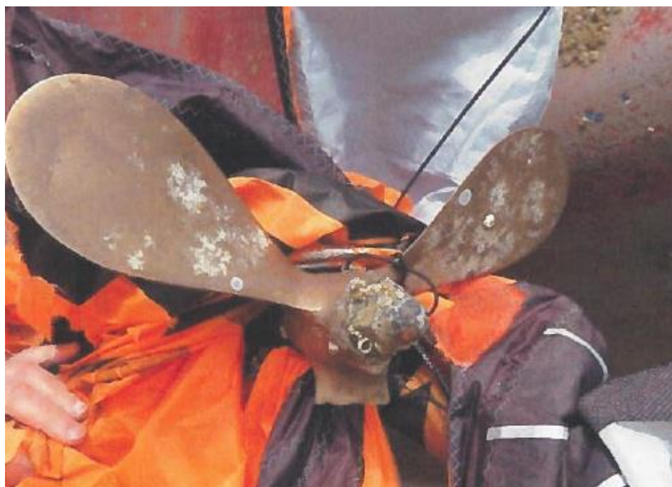
Zdjęcie nr 8. Śruba napędowa z widoczną wyłamaną 1 spośród trzech łopatek
